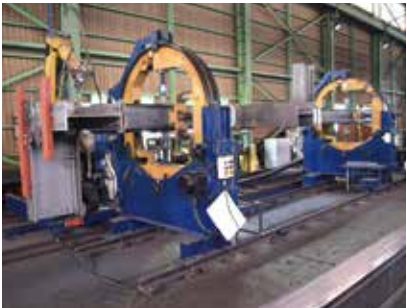
柱大組溶接ロボット 神戸製鋼所 10T-800MP1
