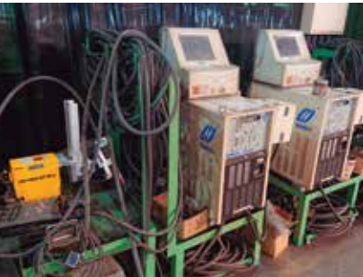
小型可搬型溶接ロボット 神戸製鋼所 IR-700REG
